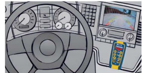
Bär SmartControl Fahrerhaussteuerung (Option) zur Steuerung des Cargolifts vom Fahrerhaus aus per Bär SmartControl Plus mit Docking Station. Siehe Technologien.
